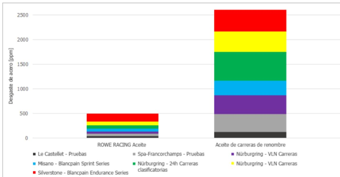
El diagrama (arriba) muestra el desgaste de acero acumulado a lo largo de varias carreras/recorridos de prueba. El desgaste de acero con el aceite de carreras de renombre (derecha) muestra que ya en la 3ra vuelta hay un desgaste mayor que si se usa el aceite ROWE RACING (izquierda) después de las 7 carreras/recorridos de prueba juntos.
